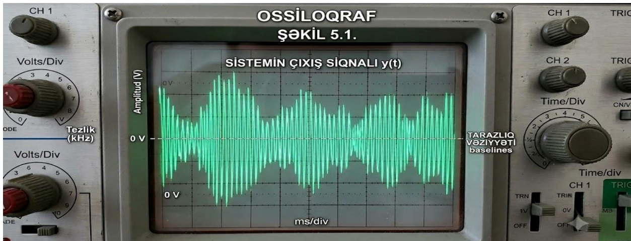
Şəkil 5.1. Böyük giriş xətası altında üçüncü tərtibli qeyri-xətti sistemin zaman domenində çıxış siqnalının ( y(t) ) ossiloqraf pəncərəsində qeydə alınmış sönməz rəqsləri
