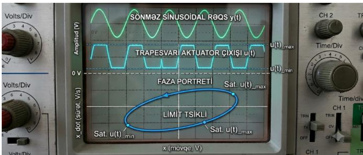
Şəkil 5.2. Aktuatorun trapesvari "bang-bang" rejimi ( u(t) ), sistemin sinusoidal çıxışı ( y(t) ) və faza müstəvisində ( x_1 vs x_2 ) formalaşmış stabil Limit Tsikli orbitinin faza portreti
